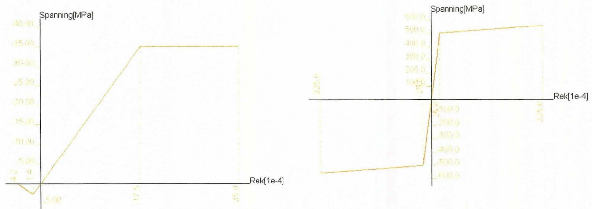
Figuur 11: \sigma - \epsilon diagrammen voor beton en staal
